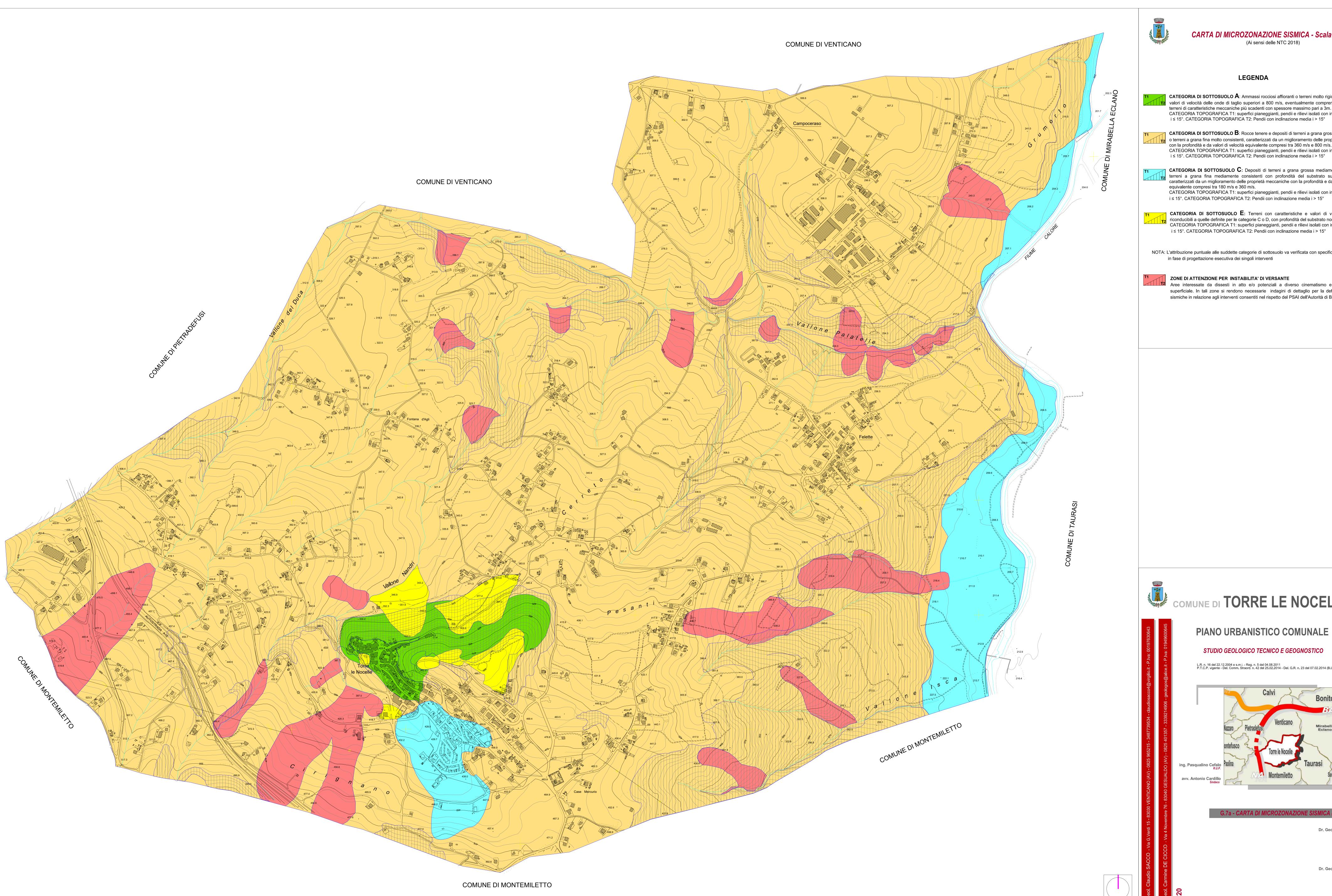
CARTA DI MICROZONAZIONE SISMICA - Scala 1:5000 (Ai sensi delle NTC 2018)
